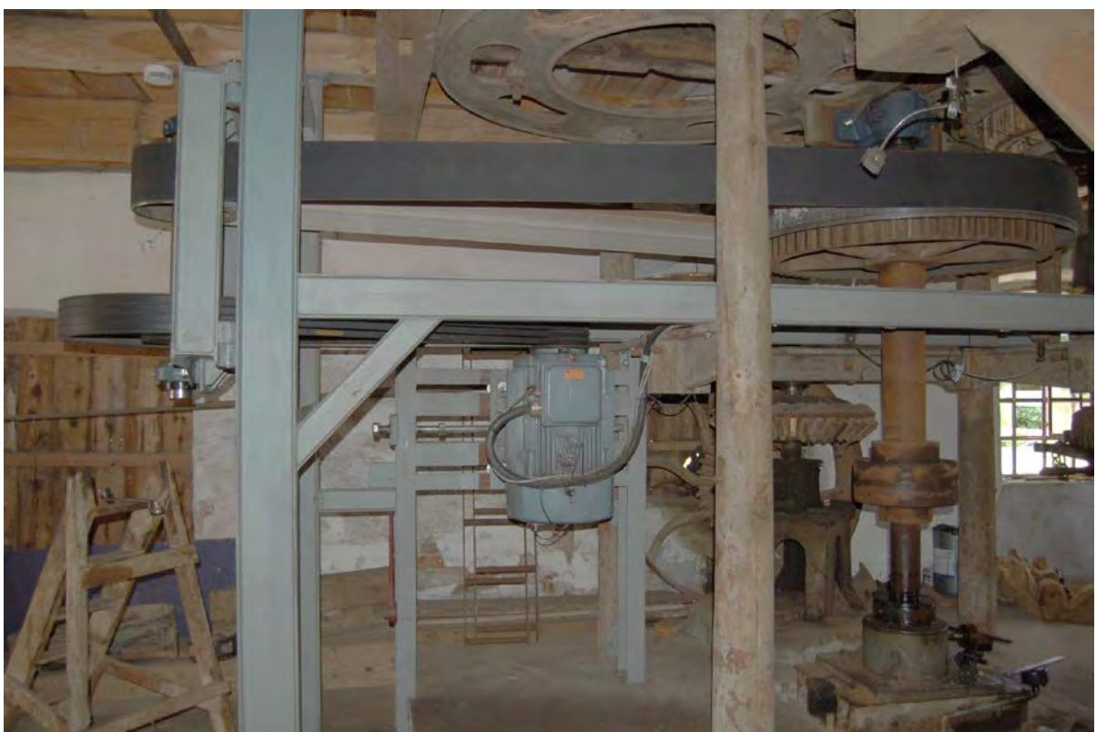
Kraftübertragung von der Francis-Turbine auf den Generator: von der Achse der Turbine läuft ein Riemen zu der Übertragung links und von dort läuft ein zweiter Riemen zu der Achse des Generators (in der Bildmitte zu sehen).
